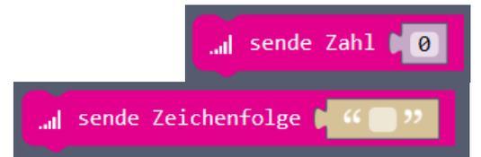
Um übertragene Daten empfangen zu können, werden entsprechende Befehle benötigt. Die übertragenen Daten befinden sich dann automatisch in „receivedNumber“ bzw. „receivedString“, je nach Übertragungsart. Sobald dieser Befehl ausgewertet wurde, ist zusätzlich eine Variable „receivedNumber“ bzw. „receivedString“ im Variablenblock zu finden. Man kann den Wert dann einer anderen Variablen zuweisen. Es handelt sich hierbei jedoch um lokale Variablen, andere Blöcke kennen den Wert der Variable nicht.
